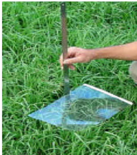
Figura-1. Esquema de medição da altura do relvado. Adaptado de Pedreira (2002).
